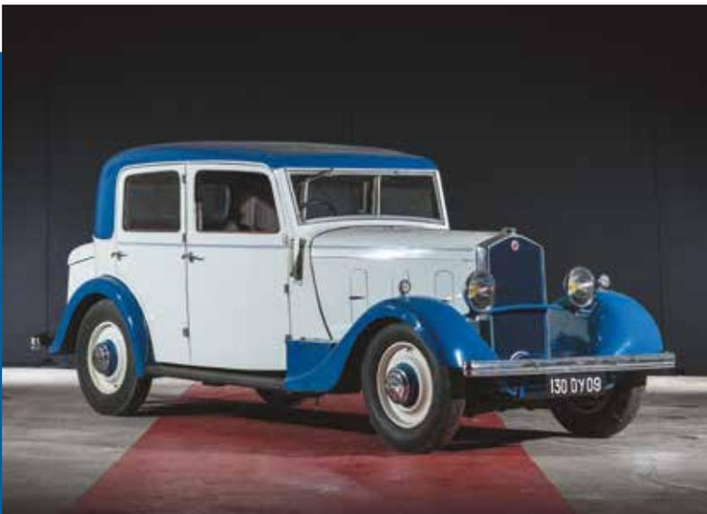
Produite entre 1931 et 1935, la L760 constituait un milieu de gamme avec son moteur 4 cylindres à soupapes latérales de 1450 cm<sup>3</sup> qui la faisait entrer dans la catégorie des 8cv.
