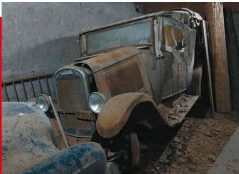
Ce charmant torpédo, précédemment immatriculé dans le Gers ainsi que l'indique une plaque fixée au support de phares, mérite une restauration complète. Ses roues, un manomètre et quelques éléments sont manquants, mais l'essentiel est présent, y compris son 4 cylindres latéral, les arceaux de capotes et mêmes les protections latérales en toile !
