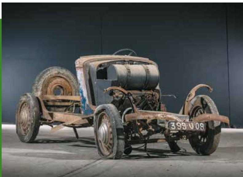
Ce châssis de Fiat Balilla 6cv est doté de ses trains roulants, de sa boîte de vitesse, de son auvent et des supports d'ailes. Le compteur et la plaque constructeur sont également présents. Banque de pièce ou base idéale pour répliquer la mythique 508S Coppa d'Oro, ce châssis offre un réel intérêt.
