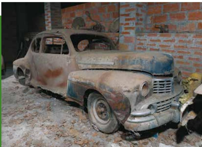
A l'état d'épave, cette Lincoln présente l'intérêt d'être encore équipée de son moteur V12, acheté par André Trigano pour éventuellement compléter son coupé Lincoln Zephyr d'avant-guerre. Les vitrages, les roues arrière ainsi que l'intérieur sont manquants. Ce coach constitue une banque de pièces particulièrement intéressante pour sa partie mécanique.
