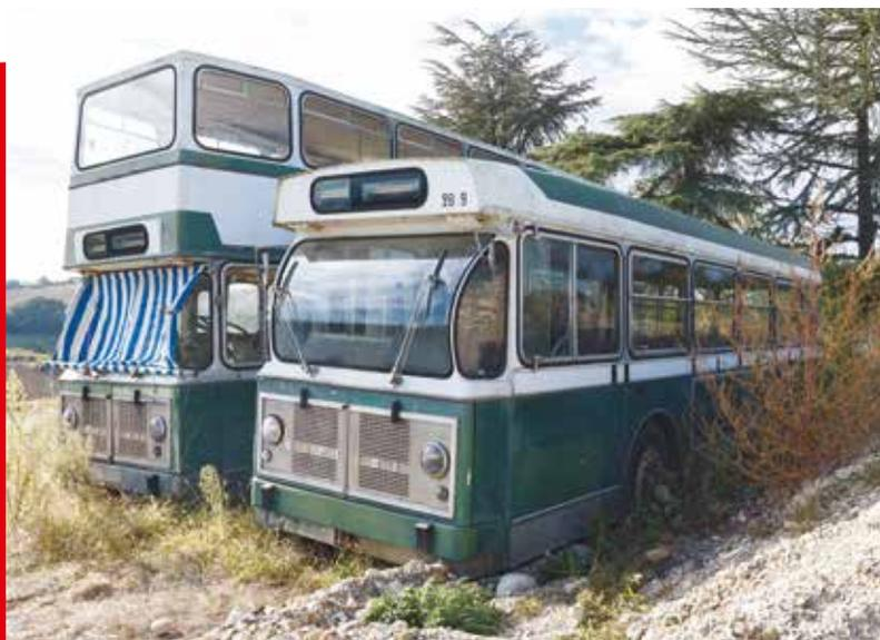
Entre 1969 et 1971, Berliet produit 560 PGR à destination de la RATP. Cet autobus destiné au transport de voyageurs avait une capacité de 28 places assises et 17 places debout. L'exemplaire présenté semble complet, et figé par le temps. Il est toujours équipé de ses rideaux roulants latéraux et le poste de pilotage semble en bon état. Il constitue un formidable et original projet pour un retour à la route ou une habitation originale.
