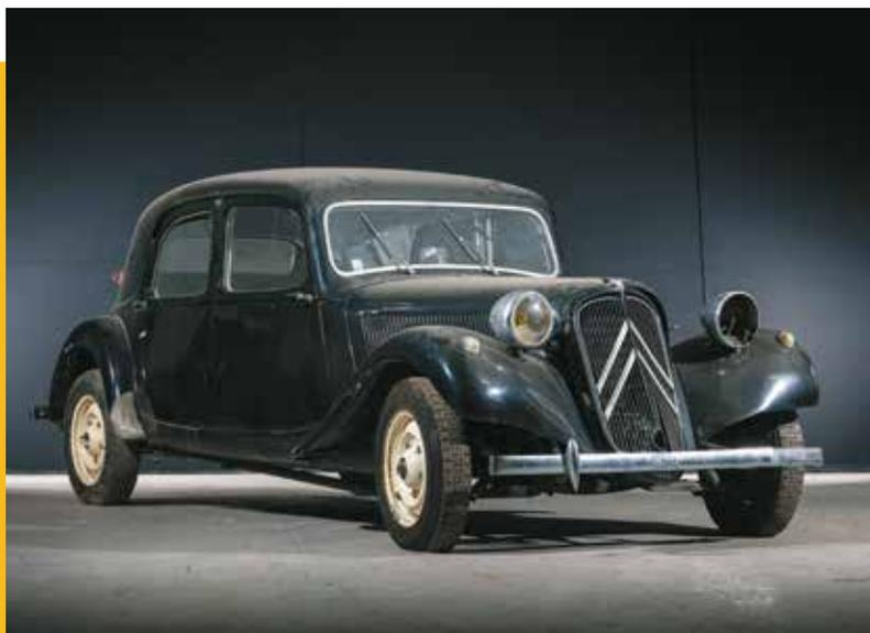
Cette Traction 11B a visiblement bénéficié d'une remise en état ancienne qu'il conviendra de reprendre. En grande partie complète, nous avons relevé que la plaque constructeur était une refabrication et que quelques éléments, dont notamment la pompe à eau, le filtre à air, ou encore un verre de phare étaient manquants.
