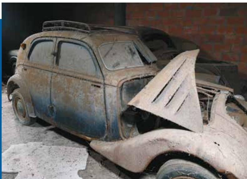
Remplaçante de la 302 à partir de 1938, la 402 légère n'est autre qu'une 302 dotée du moteur 11cv de la 402. Cet exemplaire incomplet constitue une banque de pièces enviable. La calandre, le radiateur, ou encore les phares et pare-chocs sont manquants, mais l'ensemble est agrémenté d'une galerie.
