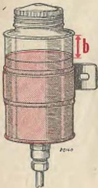
Pendant la purge, vérifiez le niveau dans le réservoir à liquide de frein, de façon à éviter de nouvelles entrées d'air.
