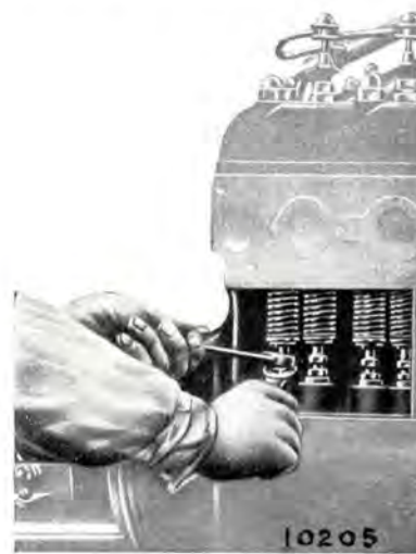
Fig. 7. — Réglage des taquets.
