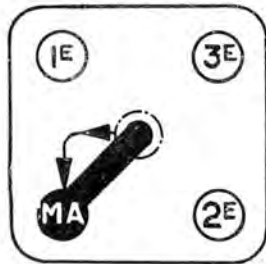
Fig. 3. 10 020 Positions du levier du changement de vitesse.
