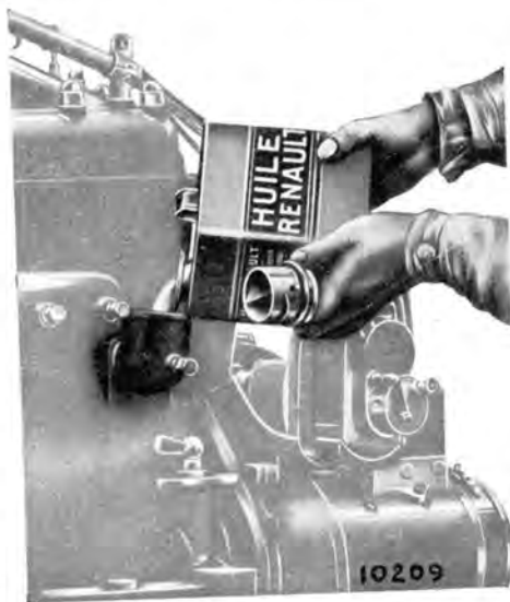
Fig. 14. - Le remplissage d'huile.
