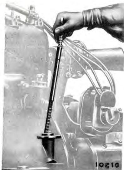
Fig. 15. — Vérification du niveau d'huile à la jauge.
