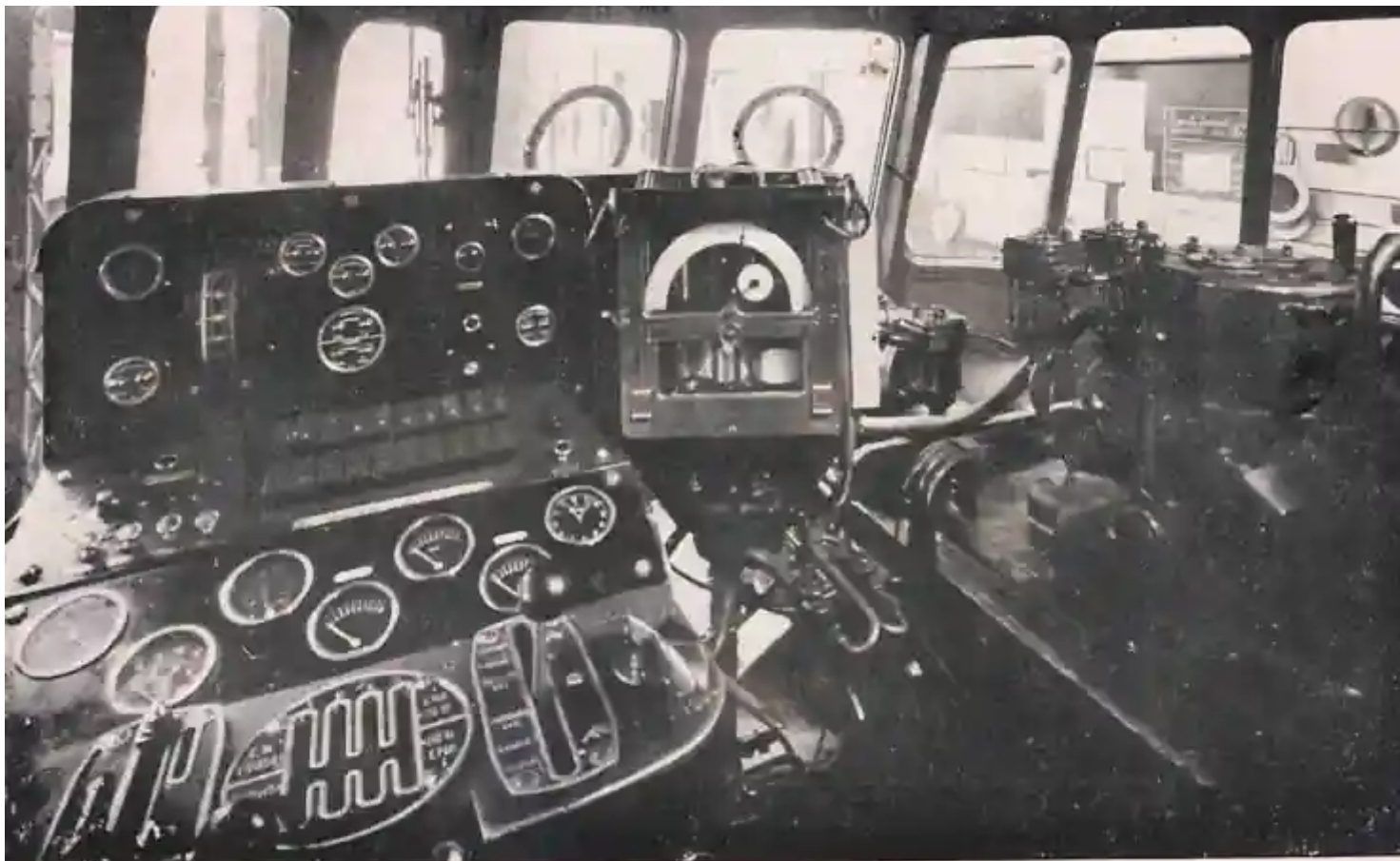
Poste de conduite d'un autorail Renault type A D P (1 moteur de 500 chevaux)
